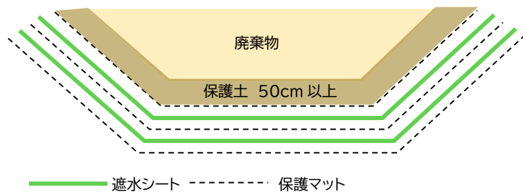
図 1.5.4 貯留構造物の遮水工断面図
